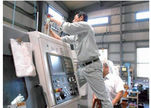
▲ 設備に光センサーもしくはリードスイッチを設置
