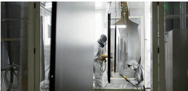
▲ 粉体ラインにおける塗装ブース
