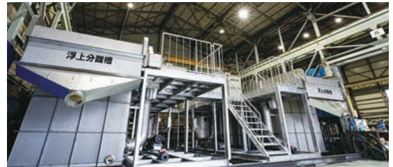
▲ 加圧浮上装置という排水処理装置を自社ブランドとして制作。
